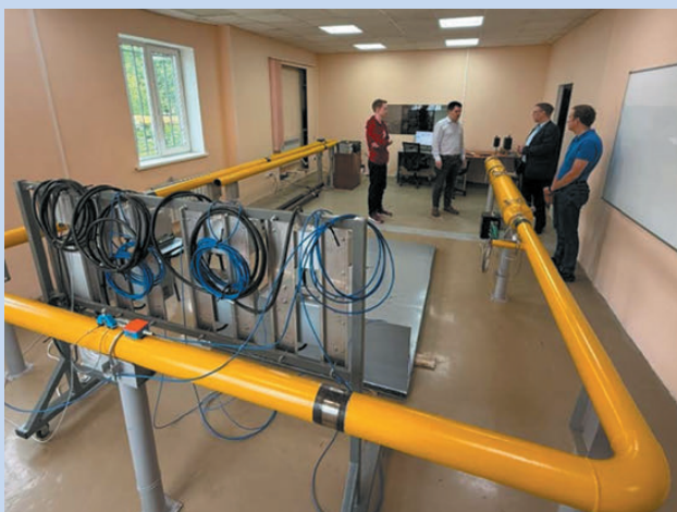
Испытательный стенд мониторинга технического состояния труб
