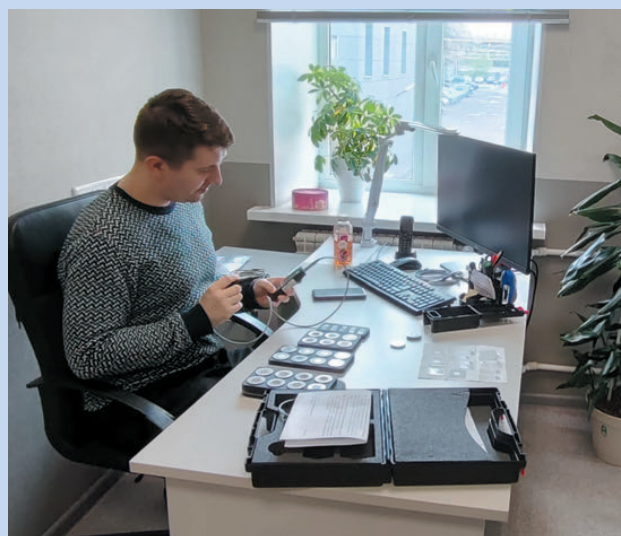
Работа с настроечными образцами, градуировка
