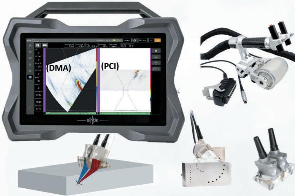
**Метод полной фокусировки (TFM)** - этот метод основан на прозвучивании каждой точки объекта контроля множества раз различными комбинациями приемных и излучающих элементов PR, при данном методе амплитуда сигнала менее зависит от ориентации дефектов по сравнению с методом фазированных решеток.
