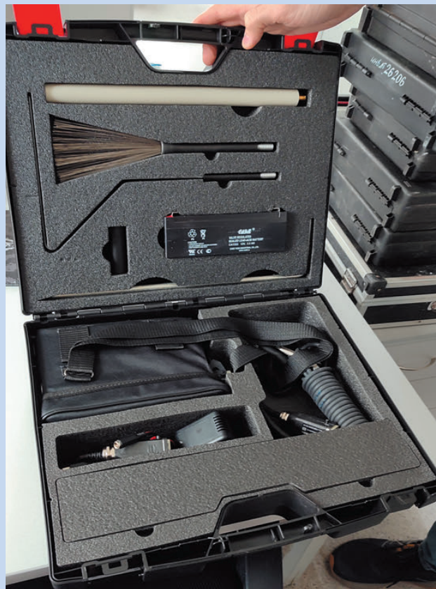
Полностью укомплектованный и проверенный дефектоскоп, включающий: электронный блок, комплект электродов, кабели и аксессуары, паспорт и руководство по эксплуатации с отметкой о первичной аттестации
