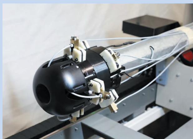
Автоматизированная система для контроля толщины покрытия на внутренней поверхности специальных труб с манжетами
