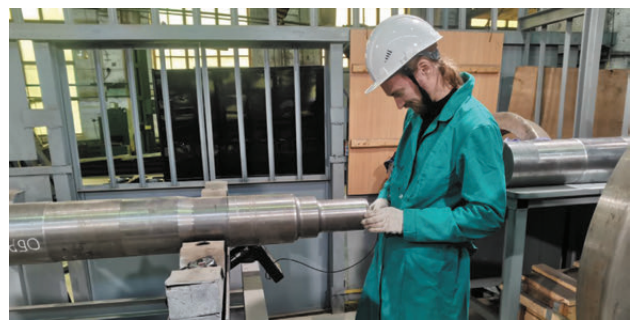
Апробация разработанной методики УЗК оси для специального подвижного состава на Камбарском машиностроительном заводе
