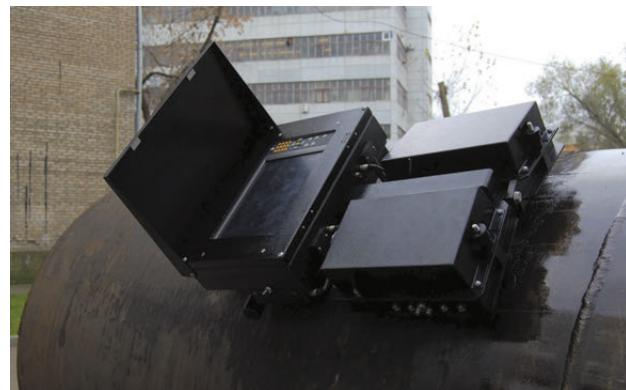
720–1420 мм на наличие дефектов типа нарушения сплошности или однородности материала. В основу работы сканера заложен принцип ввода ультразвуковой волны в тело объекта контроля с помощью электромагнитно-акустического преобразователя через зазор.
