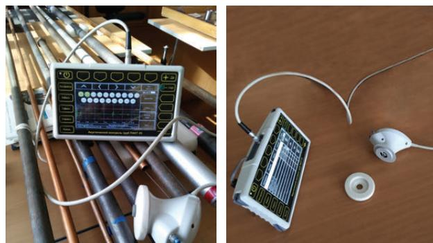
разработан стандарт организации СТО 0022022-043–2016 «Трубопроводные системы. Методы акустического контроля. Метод акустической импульсной рефлектометрии».
