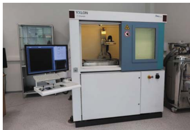
Микрофокусная система рентгеновского контроля Модель: Y.Cheetah 160 kV Производитель: YXLON, Германия
