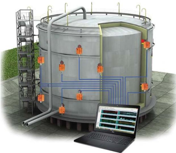
*A-Line DS-1 – новый тип многоканальных акустико-эмиссионных измерительных комплексов с высокоскоростной цифровой передачей первичных данных*
