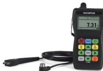
**Ультразвуковой толщиномер 27MG.** Толщиномер предназначен для прецизионных измерений остаточной толщины стенок труб при одностороннем доступе к объекту контроля.
