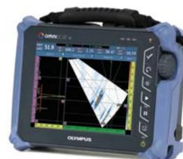
**Ультразвуковой дефектоскоп на фазированных решетках OmniScan SX.** Прибор имеет удобный программный интерфейс и оснащен 8,4-дюймовым (21,3 см) сенсорным экраном. OmniScan SX имеет две модификации — PA и UT. Первая представляет собой ФР-модуль 16:64PR, а вторая оснащается традиционным каналом УЗ.
