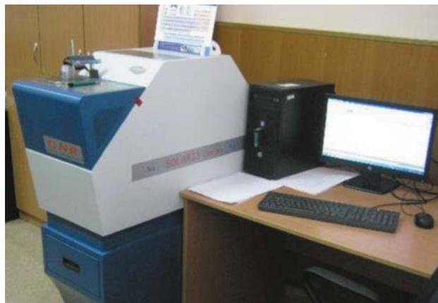
*Эмиссионный спектрометр SOLARIS CCD Plus*
