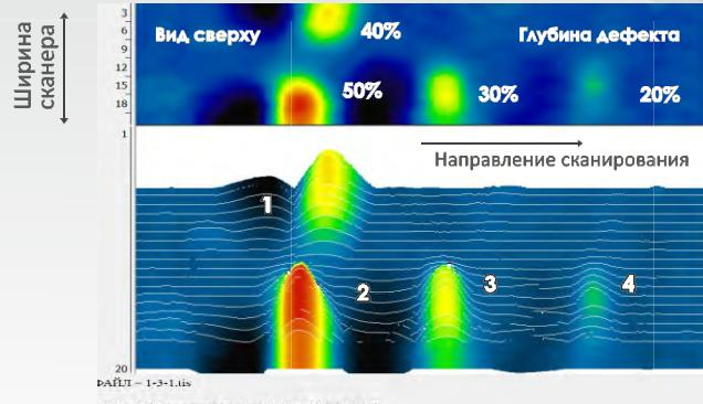
Пример обнаружения коррозионного повреждения на внутренней поверхности стенки трубопровода
