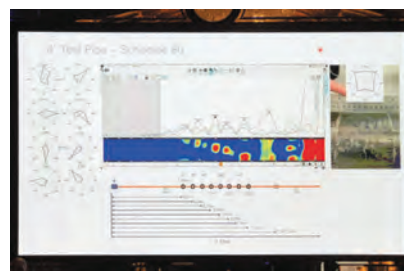
Калибровка системы магнитоэлектрического волноводного контроля на эталоне (имитаторе дефектов)
