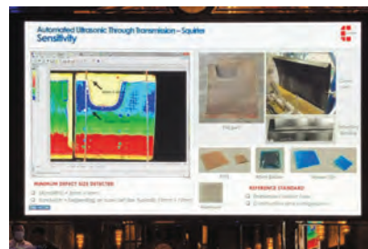
Автоматизированный и автоматический иммерсионный ультразвуковой контроль крупногабаритных композиционных конструкций для Airbus 350 и Boeing 787 на Малайзийском предприятии STRM, где они серийно изготавливаются
