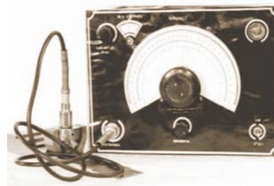
Рис. 12. Общий вид одной из первых моделей ультразвукового толщиномера (автор И.В. Лопатко)
