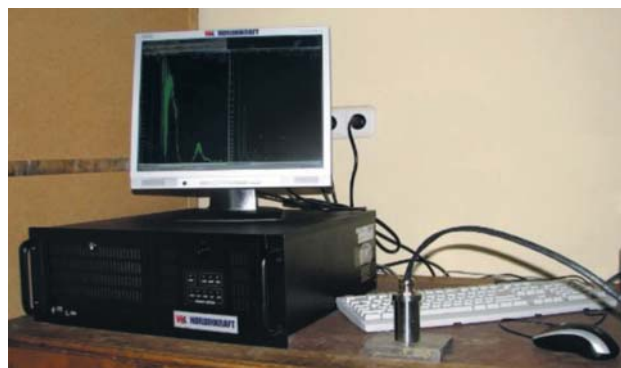
Рис. 22. Лабораторный макет толщиномера с ЭМАП
