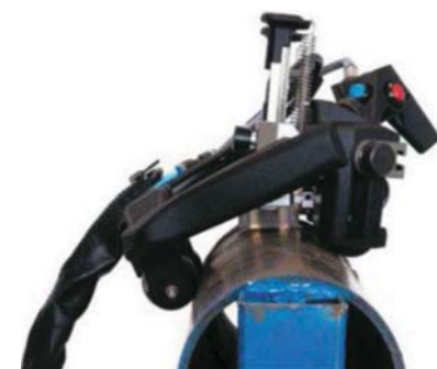
Рис. 2. Боковая проекция сканера AxSEAM в конфигурации с двумя (а) и четырьмя (б) преобразователями на кольцевом сварном шве
