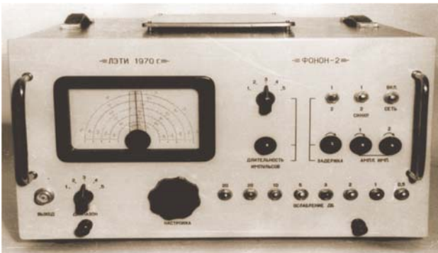
Рис. 8. Опытный образец высокочастотного измерителя скоростей упругих волн «Фонон»
