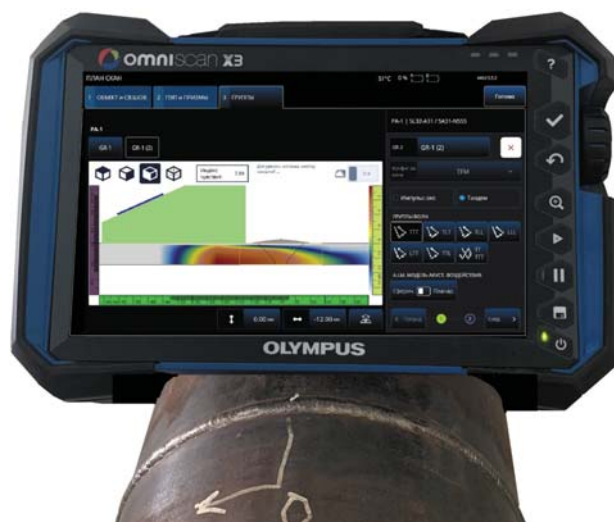
Рис. 1. Дефектоскоп OmniScan X3 в режиме моделирования карты акустического воздействия AIM
