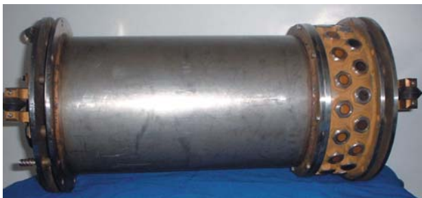
Рис. 13. Неавтономный ультразвуковой внутритрубный толщиномер-снаряд для контроля труб, заглубленных в грунт
