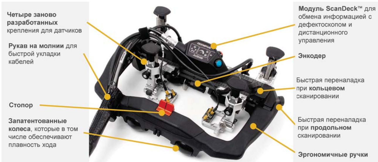
Рис. 3. Основные компоненты сканера AxSEAM
