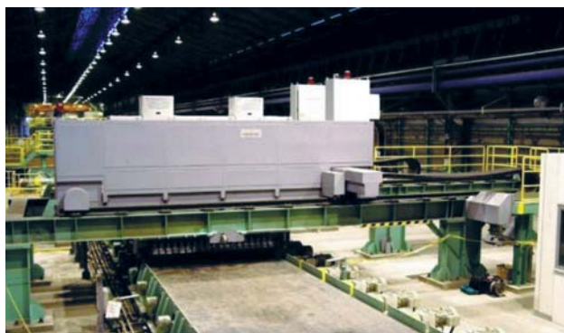
Рис. 21. Установка с ЭМАП для контроля листового проката («Ниппон стил», Япония)
