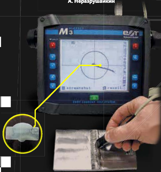
Вихретоковый контроль сварных соединений
