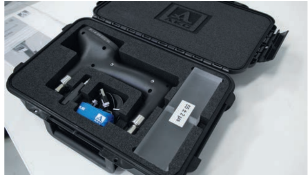
Оборудование, укомплектованное и готовое к продаже: ультразвуковой тестер UK1401
