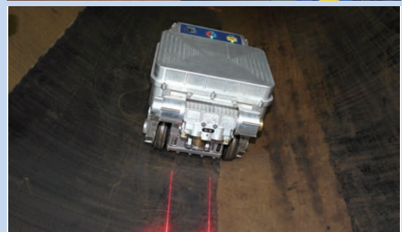
Внутритрубные сканеры на полигоне для испытания приборов и оборудования
