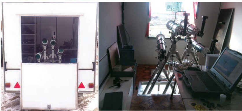
Рис. 6. Оборудование передвижного измерительного модуля: а – вид снаружи; б – вид изнутри на состав оборудования
