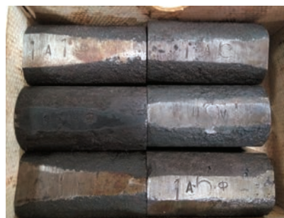
Рис. 2. Комплект образцов из чугуна для ультразвуковой структуроскопии
