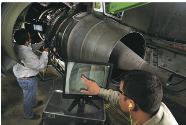
Видеоэндоскоп OLYMPUS IPLEX RX. Эндоскопическое изображение просматривается двумя операторами одновременно
