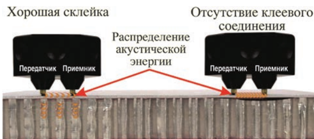
Рис. 3. Импедансный контроль. Раздельно-совмещенный преобразователь
