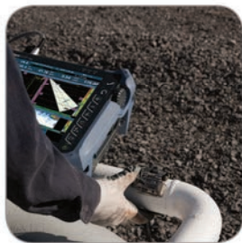
Контроль сварных швов труб малого диаметра
