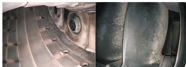
Изображения камеры сгорания авиационного двигателя (слева) и лопатки компрессора ГТД (справа) – вид через видеоэндоскоп IPLEX RX
