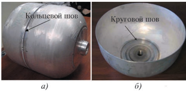
Рис. 2. Объект контроля: а – лейнер в сборе; б – полулейнер
