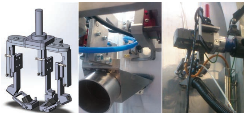
Рис. 5. Оснастка ультразвуковой головки для проведения автоматизированного УЗК сварных швов
