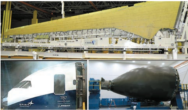
Рис. 2. Примеры несущих конструкций, целиком выполненных из композитов
