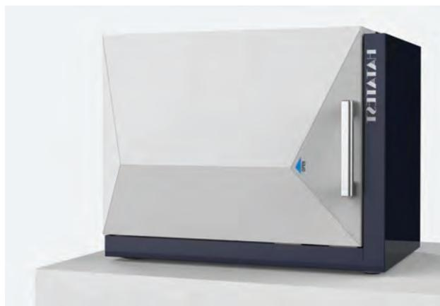
Предназначена для неразрушающего контроля качества сложных, многослойных пластинчатых образцов (например, печатных плат). Установка может работать в режимах компьютерной томографии и ламинографии. Использование режима ламинографии позволяет улучшить обнаружение дефектов.
