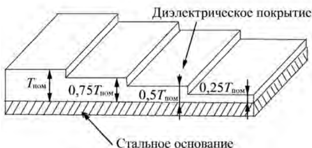
Рис. 3. Настроечный образец для настройки чувствительности электроискрового дефектоскопа ЭК-03П с изменяющейся толщиной покрытия
