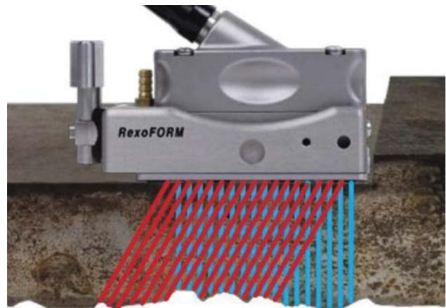
Рис. 3. Коррозионный мониторинг прямым и наклонным лучом
