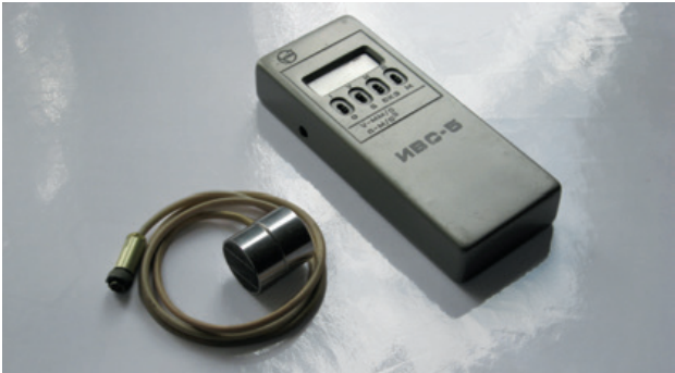
Виброметр ИВС-5 образца 1991 г.
