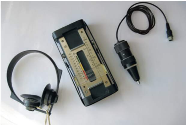
Индикатор ударных импульсов ИСП-1 образца 1991 г.
