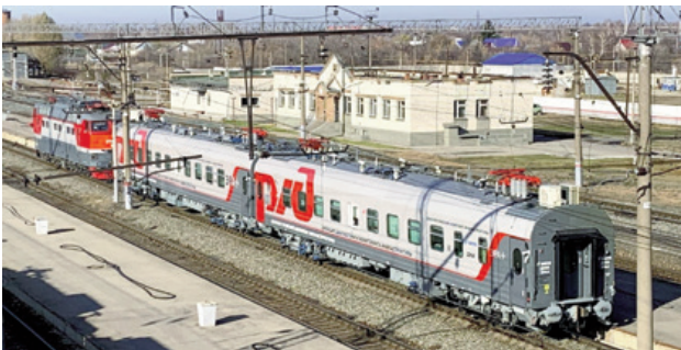
Рис. 1. Высокоскоростной диагностический комплекс инфраструктуры «ЭРА+» (дефектоскопическая система производства АО «Радиоавионика»)
