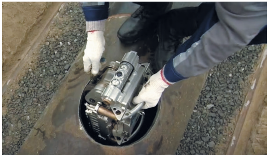
Рис. 6. Загрузка ВРДК А2072 через технологическое отверстие
