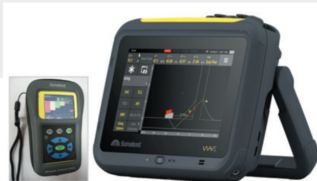
Толщиномер T-GageVCDLW (0,2 кг, 50×127×32 мм) и дефектоскоп Harafang Wave (1,7 кг, 222×174×63 мм)
