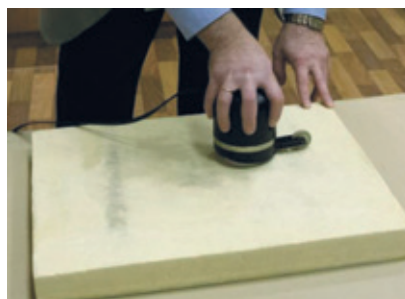
Сканирование образца теплозащитного материала голографическим радаром «РАСКАН-5/7000» и восстановленная картина заложенных внутренних дефектов
