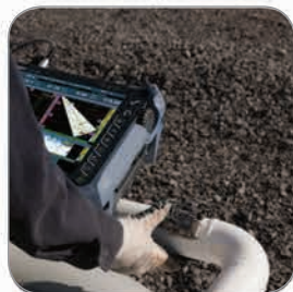
Контроль сварных швов труб малого диаметра
