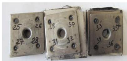
Рис. 4. Образцы рельефной сварки
