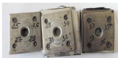
Рис. 4. Образцы рельефной сварки
