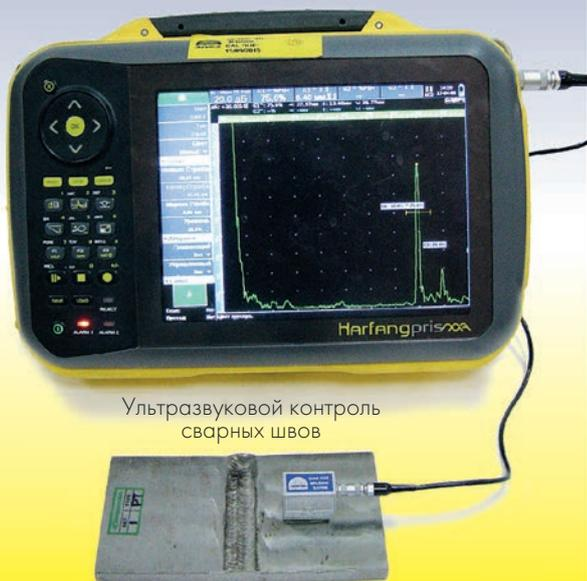
Ультразвуковой контроль сварных швов
