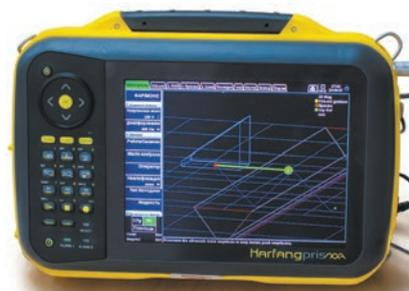
Рис. 2. Ультразвуковой дефектоскоп Harfang Prisma UT
