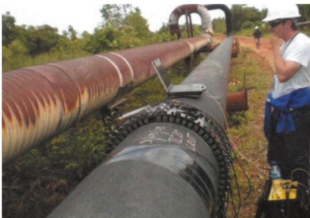
Рис. 3. Низкочастотная ультразвуковая диагностика
