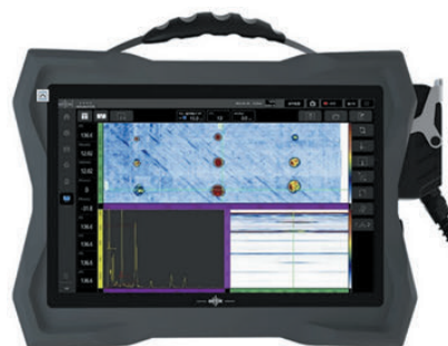
Рис. 1. Внешний вид перспективного ультразвукового дефектоскопа с ПФР
