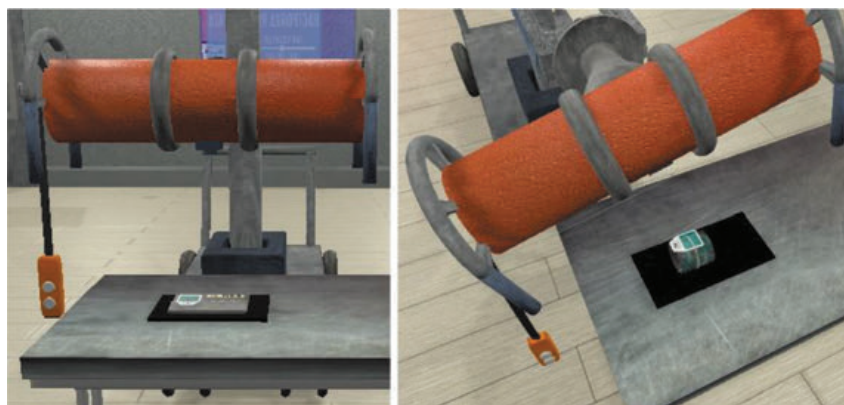
Рис. 4. Цифровой двойник РГ-установки с аутентичным управлением
