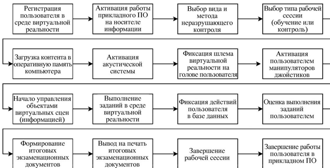
Рис. 1. Последовательность действий пользователя при обучении в виртуальной среде
