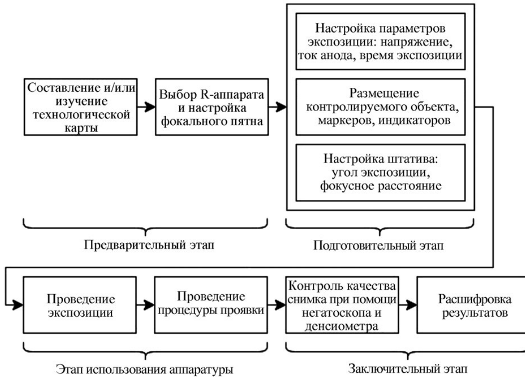
Рис. 2. План работы в виртуальной лаборатории
