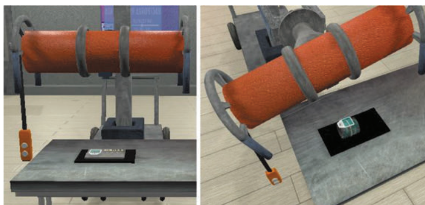
Рис. 4. Цифровой двойник РГ-установки с аутентичным управлением
