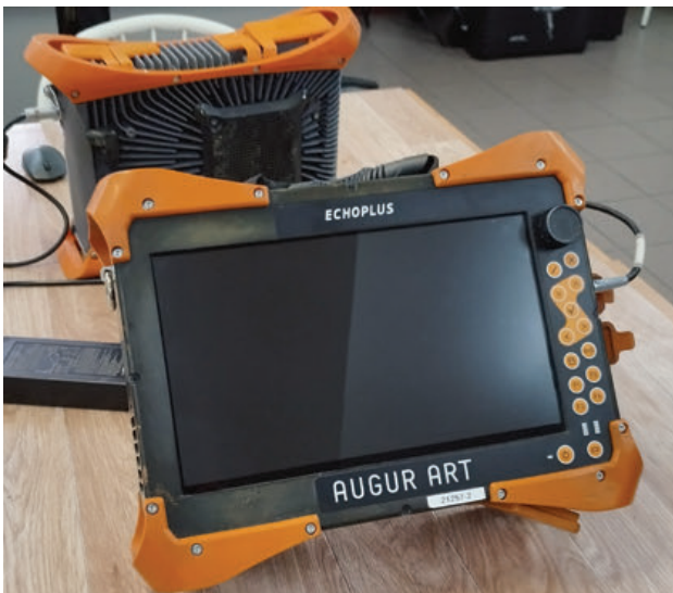
Дефектоскоп «АВГУР-АРТ» в ручном и автоматизированном исполнении (до 512 каналов)
