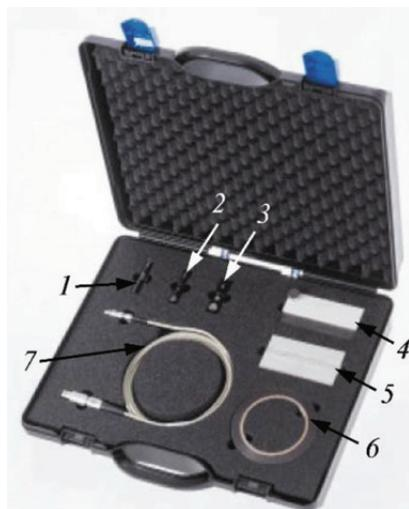
Рис. 3. Набор для контроля сварных швов через лакокрасочное покрытие: 1 – преобразователь для контроля толщины покрытий; 2, 3 – преобразователи для контроля сварных соединений; 4 – настроечный образец для измерения толщины покрытия; 5 – настроечный образец для контроля сварных соединений; 6 – кабель для подключения преобразователей; 7 – защитная тефлоновая лента
