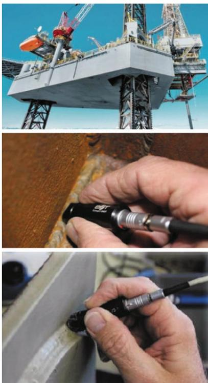
Рис. 2. Вихретоковый контроль сварных швов
