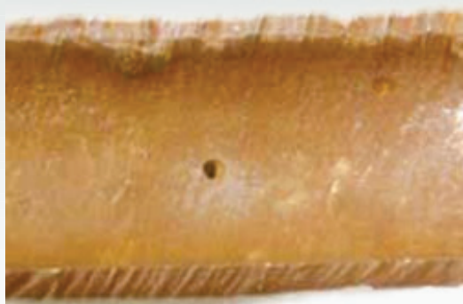
Пример обнаружения коррозионного повреждения на внутренней поверхности стенки трубопровода
