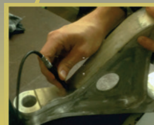
Вихретоковая дефектоскопия ответственных узлов авиационной техники с помощью ELOTEST M3
