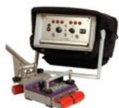
**Handscan (Silverwing)** – MFL-сканер днищ резервуаров и плоских поверхностей. Компактный размер, постоянные магниты последнего поколения обеспечивают высокий уровень насыщения инспектируемой зоны.
