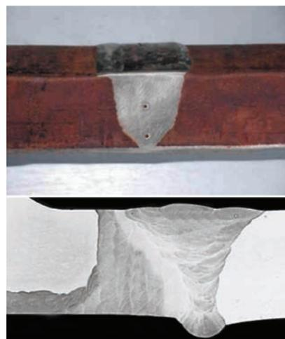
Рис. 1. Плакированная труба со сварным соединением из коррозионно-стойкой стали (сверху) и сварной шов, соединяющий два различных материала — легированную и углеродистую сталь (снизу)
