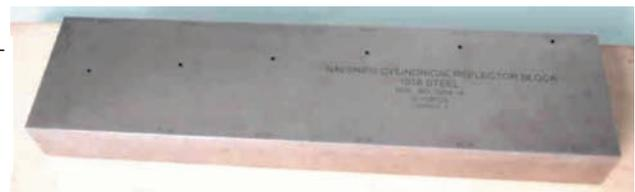
При выборе калибровочного блока требуется учесть два основных параметра: чувствительность калибровки и воспроизводимость результатов контроля:
