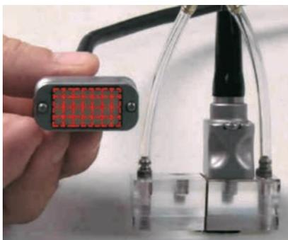
Рис. 6. На призму установлен DMA ПЭП, состоящий из двух преобразователей по 28 элементов каждый в виде фазированной решетки
