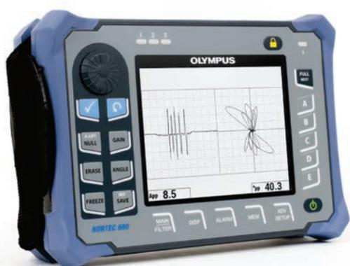
Для выполнения контроля труб теплообменников и кондиционеров достаточно одного оператора и комплекта оборудования на базе вихретокового дефектоскопа NORTEC 600D. Одна система позволяет осуществлять полный контроль оребренных и неоребренных труб из ферромагнитных и неферромагнитных материалов, и не требует много времени на освоение.
