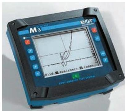
*Рис. 2. Внешний вид вихретокового дефектоскопа Elotest M3*
