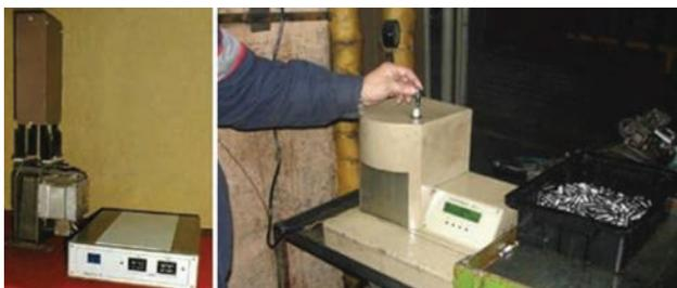
Прибор «МАКСИ-П» и контроль качества лекальной ТВЧ-закалки болтов
