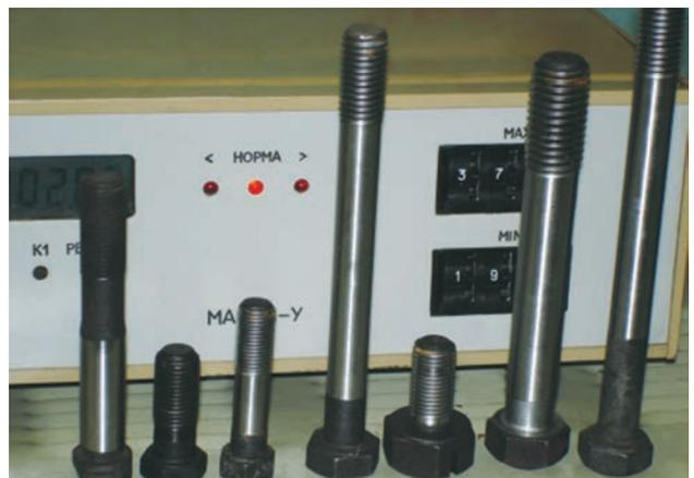
*Ответственные болты разных типов, возвращенные в производство после неразрушающего контроля*
