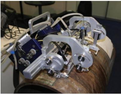
комплекс МВК-ИКН на базе прибора ИКН-8М-4, в котором совмещены функции магнитного (метода магнитной памяти металла) и вихретокового контроля изделий.
