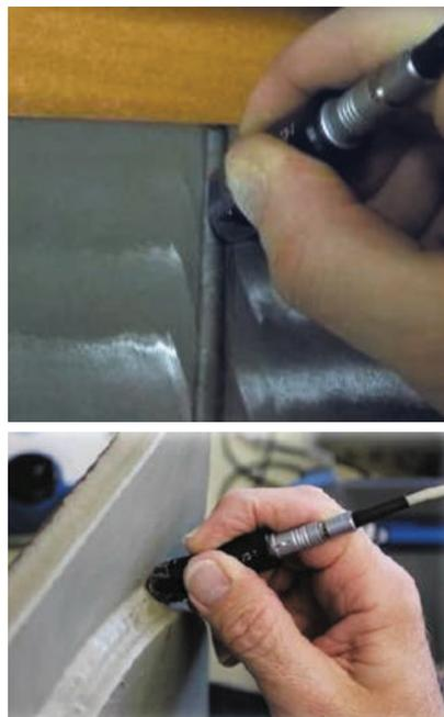
*Рис. 1. Вихретоковый контроль сварных соединений*
