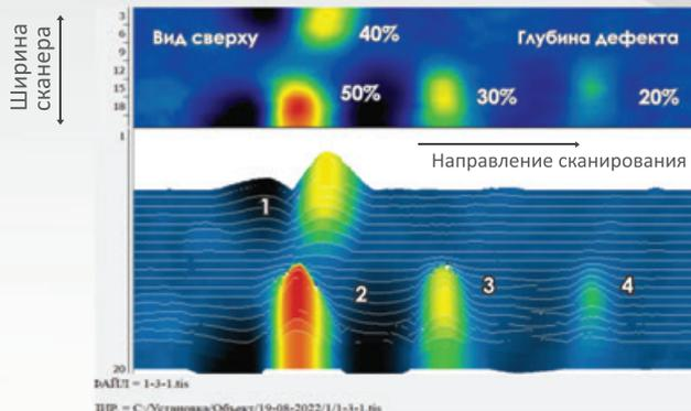
Пример обнаружения коррозионного повреждения на внутренней поверхности стенки трубопровода
