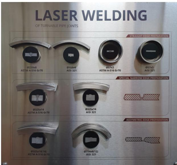
Рис. 3. Учебный стенд по лазерной сварке, НТО «ИРЭ-Полюс»
