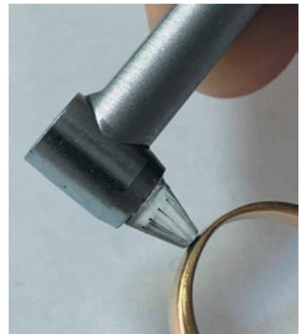
Рис. 3. УЗК кольца из золота преобразователем Sonopen®
