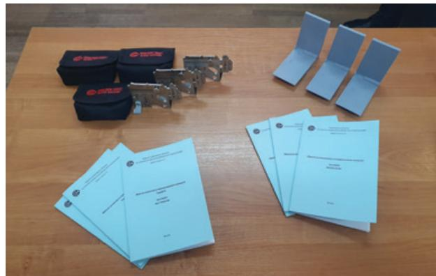
Рис. 4. Шаблоны TаріRUS и образцы по визуальному и измерительному контролю
