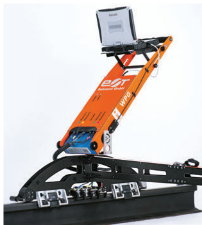
Рис. 1. Вихретоковая система ELO-RAIL
