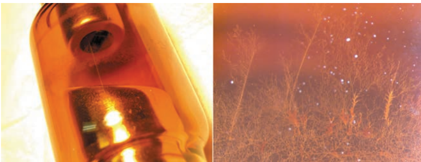
Рис. 9. Стеклянная оболочка с протравлениями, образовавшимися под действием электрического поля
