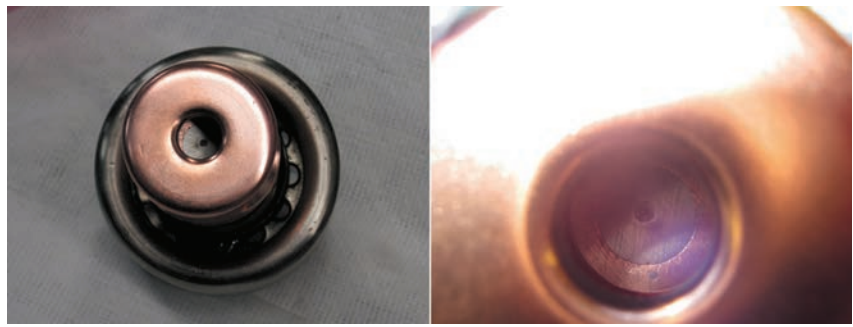
Рис. 11. Повреждение фокусного пятна из-за недостаточного охлаждения анода и термомеханического воздействия
