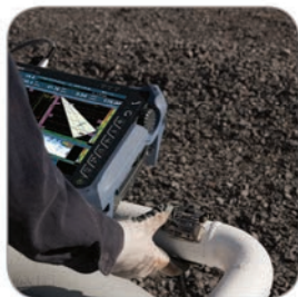
Контроль сварных швов труб малого диаметра
