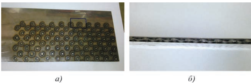
Рис. 5. Изображение внешнего вида трехслойного образца с двойной точечной сваркой: а – вид сверху; б – вид с торца
