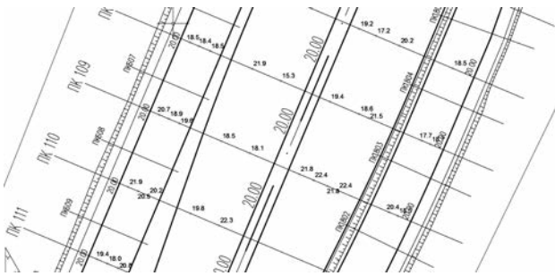
Рис. 3. Фрагмент плана с результатами георадарной съемки толщины асфальтобетона: толщина слоя асфальтобетона указана в виде точек с подписями, шаг поперечников 20 м вдоль трассы
