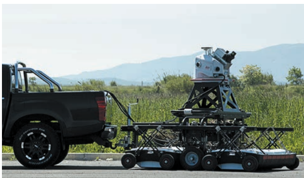
Рис. 1. Оборудование для георадарно-лазерного сканирования
