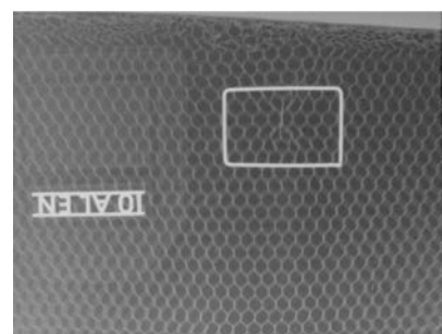
Рис. 3. Цифровое изображение фрагмента сотовой конструкции закрывка крыла самолета с локализацией дефектного участка для подробного исследования с помощью детектора S10811-11
